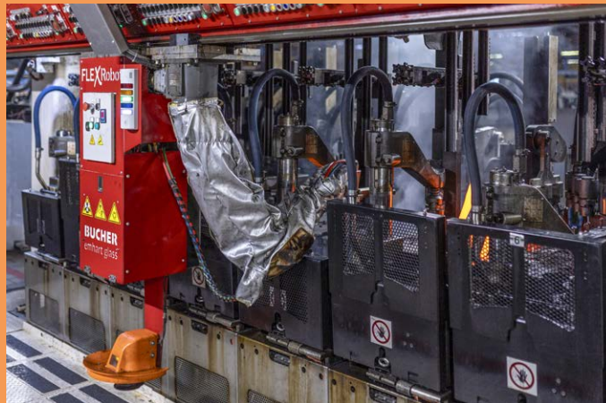
Robot za podmazivanje na NIS stroju radi visokoprecizno – prekretnica za suvremenu proizvodnju u Kyjovu.
