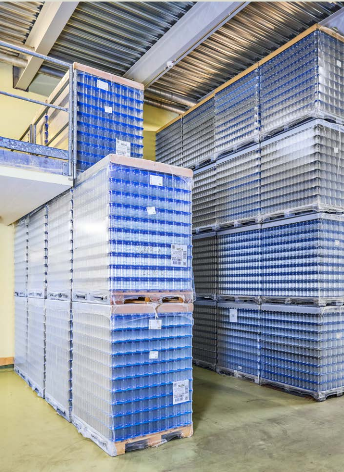
Díky optimalizaci sklenic na koření lze na jedné paletě přepravit o jednu vrstvu více. Tato optimalizace vede navíc k celkové úspoře hmotnosti přibližně 190 tun skla ročně.
