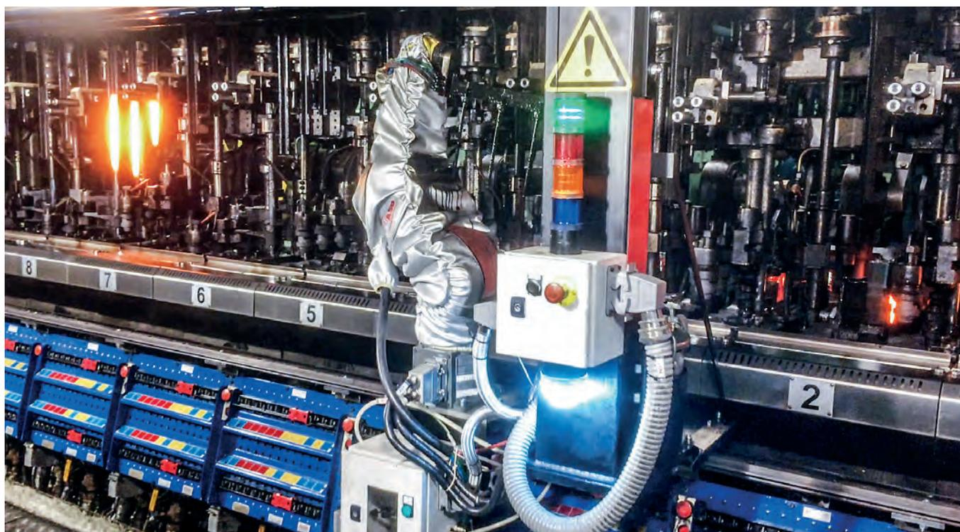
Una delle principali mansioni di un operatore durante la produzione è l'applicazione uniforme e precisa della pasta all'olio di grafite sugli stampi del preparatore e sui meccanismi di apertura e chiusura, a intervalli regolari, usando un applicatore a pennello. Questo è assolutamente essenziale per assicurare la qualità di ogni singolo articolo ma poiché ogni operatore ha un suo modo di lavorare, in un ciclo produttivo di 24 ore possono esserci discrete differenze.
