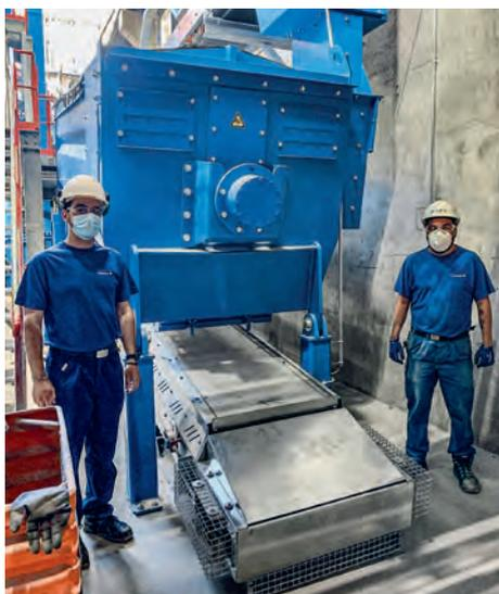
A St-Prex viene utilizzato fino all'80% di materiale riciclato per la produzione del vetro. In altre parole, ogni anno si fondono 100.000 tonnellate di vetro usato. Per trattare i rottami conferiti in modo ancora più efficiente, all'inizio dell'estate Vetropack ha installato una macchina per la rimozione delle etichette nello stabilimento di St-Prex.
