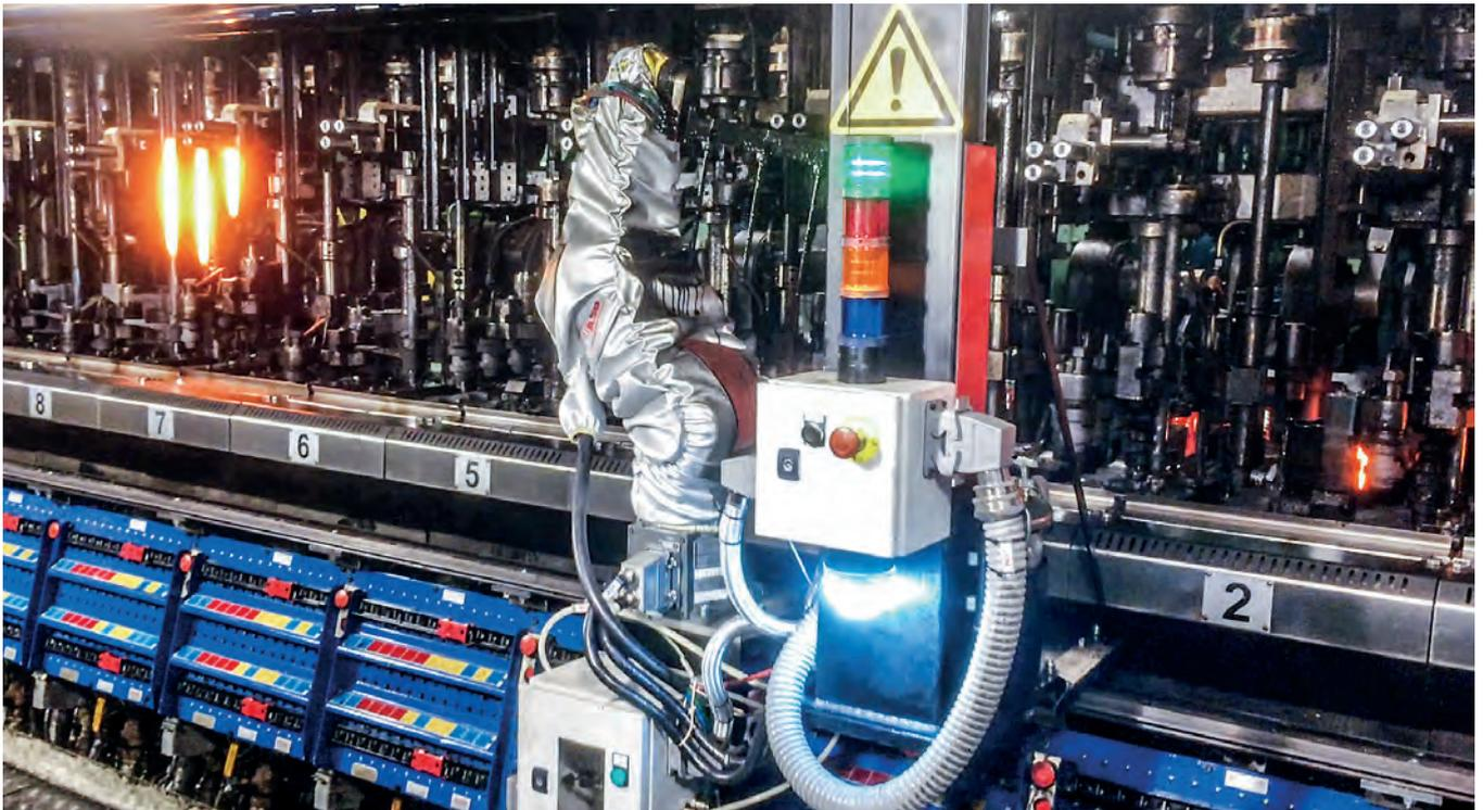
Eine der Hauptaufgaben des Maschinenführers in der Produktion ist es, in regelmäßigen Abständen mit einem bürstenartigen Pinsel eine Öl-Graphitpaste gleichmäßig und präzise auf die Vorformen und Mündungswerkzeuge aufzutragen. Dies ist für die Qualität der einzelnen Artikel absolut entscheidend. Da jeder Maschinenführer seinen eigenen Arbeitsstil hat, können im 24-stündigen Produktionszyklus durchaus Variationen auftreten.
