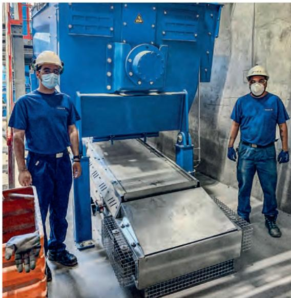
In St-Prex werden bis zu 80 Prozent Scherben für die Glasproduktion eingesetzt. Mit anderen Worten, pro Jahr werden 100'000 Tonnen Scherben eingeschmolzen. Um die angelieferten Scherben noch effizienter zu bearbeiten, hat Vetropack im Frühsommer im Glaswerk in St-Prex eine Etikettenentfernungsanlage in Betrieb genommen.
