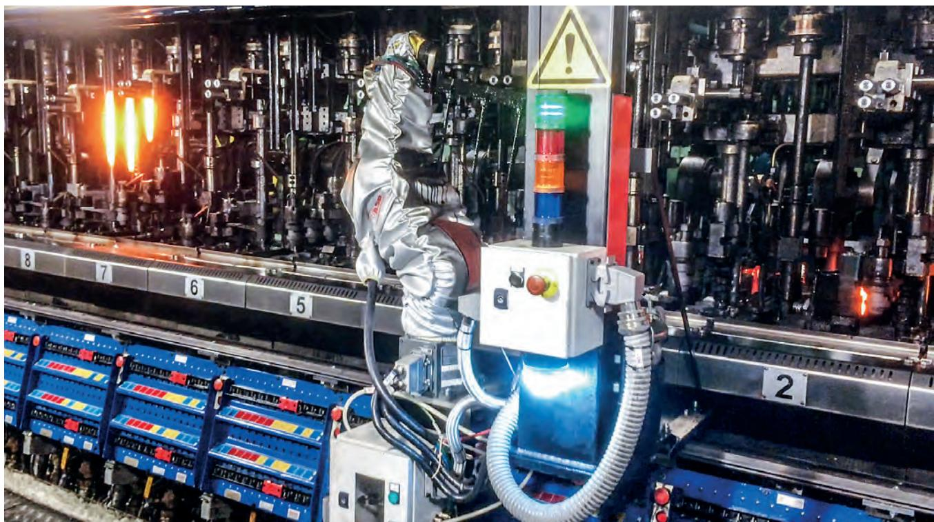
Jedna od glavnih zadaća operatera staklarskog stroja jest u redovnim razmacima kistom sličnom četki ravnomjerno i precizno nanositi uljno-grafitnu pastu na pretkalupe i kalupe grla. To je apsolutno presudno za kvalitetu svakog artikla. Budući da svaki operater ima vlastiti stil rada, u 24-satnom proizvodnom ciklusu može doći i do odstupanja.
